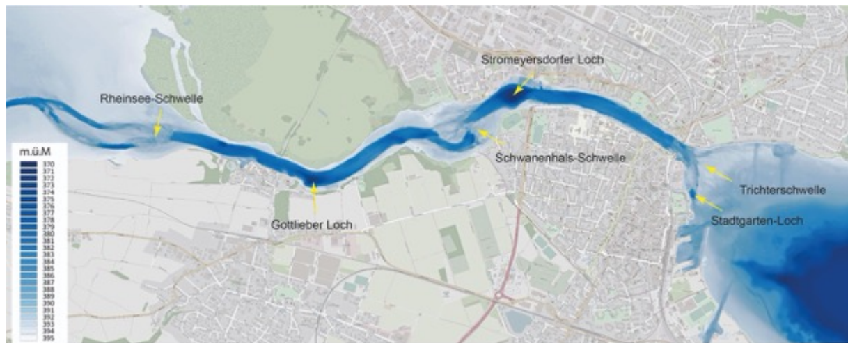
Abb. 2.3: Tiefenrelief des Seerheins mit angrenzenden Seeteilen. Die neuesten Vermessungen des Seebodens im Rahmen des Projekts «Tiefenschärfe» ( https://m.igkb.org ) zeigen zwischen dem Seeabfluss und dem Mündungstrichter eine Folge grossräumiger Perioden (Schwellen-Kolk-Wechsel) mit unterschiedlich tiefen Rinnen und unterschiedlich breiten Flachwasserbereichen.
