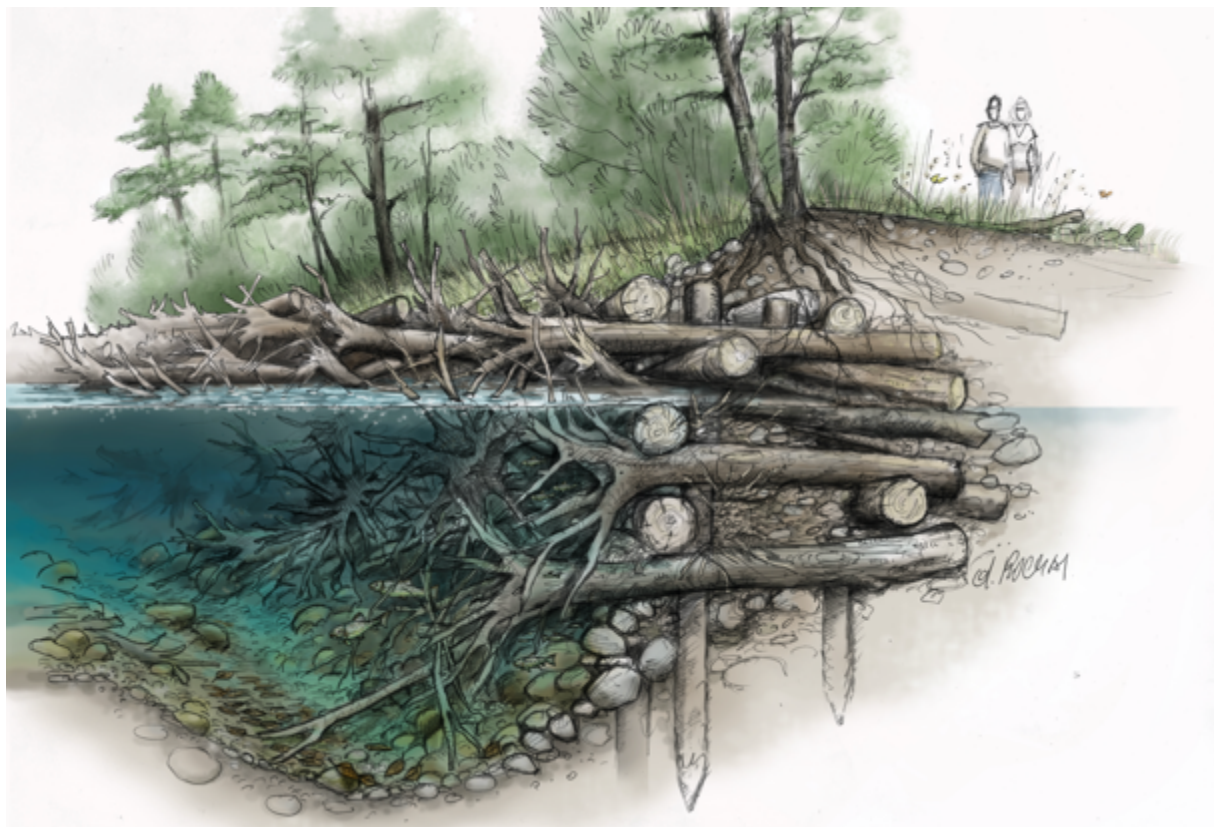
Abb. 7.5: Prinzipieller Aufbau einer Engineered Log Jam (ELJ) zur naturnahen Ufersicherung und Lebensraumanreicherung nach Widmer et al. (2019). Der Hauptbestandteil eines ELJs sind baumstammdicke Verankerungsposten, dazwischen werden Baumstämme mit Wurzelstöcken und Astbündel eingebaut. Der Aufbau kann auch unregelmässig erfolgen. Durch diesen Aufbau entsteht eine stabile, grobe Struktur, die reich an Oberflächen und Zwischenräumen, sich durch Gehölbewuchs selbst erneuern kann und weiteres Totholz abfängt. ELJs können als Längsverbau, Bühnen oder Inseln / Strömungsteiler eingesetzt werden. Grafik: Denis Rochat ( www.emchberger.ch ).
